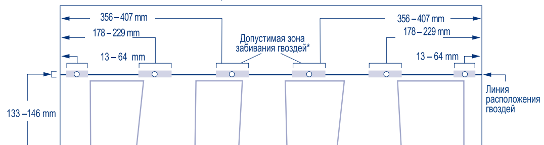
Схема крепления шестью гвоздями
