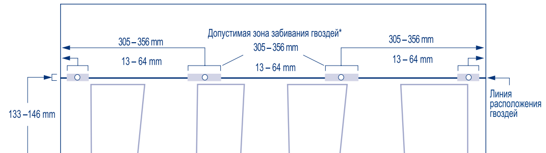
Схема крепления четырьмя гвоздями
